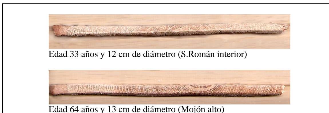
Figura 7. Secciones de incremento de árboles con similar diámetro y edades distintas que muestran la plasticidad de la especie para crecer a distintos ritmos.
